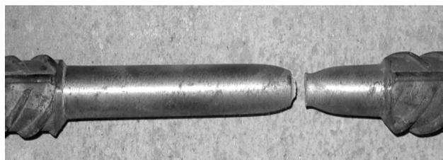
Рис. 2. Образцы из арматуры Ø32 мм
