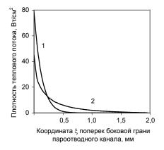
Рис. 4. Зависимость плотности теплового потока от координаты поперек боковой грани пароотводного канала (пароотводные каналы типов 1, 2)
