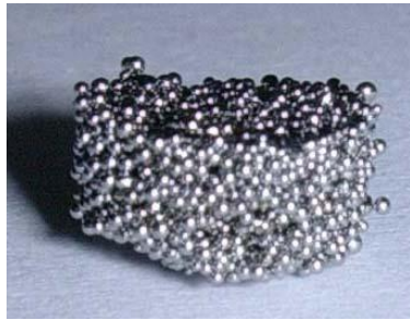
Рис. 4. Полученный образец пористого материала
