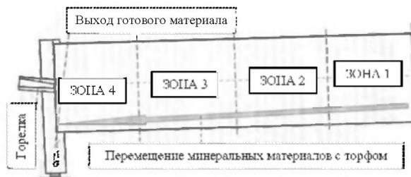
Рис. 3. Зональная физическая модель процессов, протекающих в сушильно-нагревательном барабане
