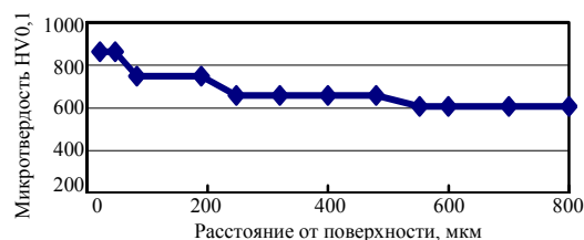
Рис. 7. Микротвердость стали Х12МФ при борировании в кипящем слое
