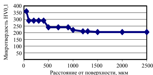
Рис. 5. Микротвердость стали 20 при борировании в кипящем слое
