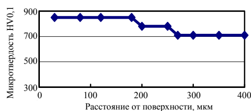
Рис. 6. Микротвердость стали 4X5МФс при борировании в кипящем слое
