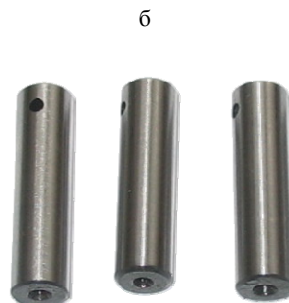
Рис. 2. Общий вид установки и образцы, используемые при испытании износостойкости трехвалковым методом: а – установка I-47-K-54; б – комплект образцов для исследований
