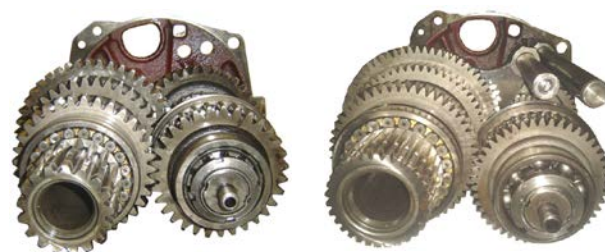
Рис. 7. Фрагменты узла передач серийной ( \epsilon_\alpha < 2 ) и опытной ( \epsilon_\alpha > 2 ) коробок передач
