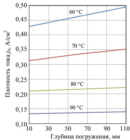
Рис. 2. Зависимость  $j_0$  от температуры электролита и глубины погружения при рабочем напряжении 280 В
