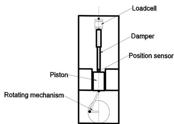
Fig. 4. Damper test stand
