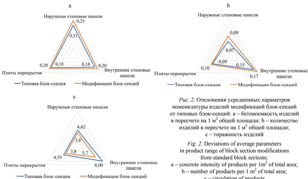
Рис. 2. Отклонения усредненных параметров номенклатуры изделий модификаций блок-секций от типовых блок-секций: а – бетоноемкость изделий в пересчете на 1 м<sup>2</sup> общей площади; б – количество изделий в пересчете на 1 м<sup>2</sup> общей площади; в – тиражность изделий
