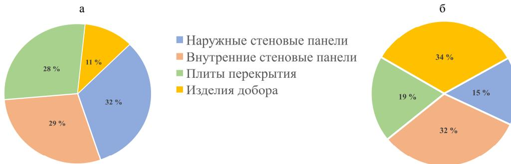
Рис. 1. Доля изделий в номенклатуре типовых серий: а – по бетоноемкости изделий, м<sup>3</sup>; б – по количеству изделий, шт.
