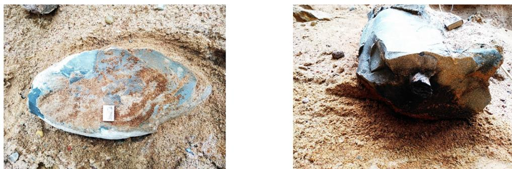
Рис. 8. Фотографии вскрытых поперечных сечений корней анкеров, сформированных в песках средней плотности в геотекстильной оболочке
