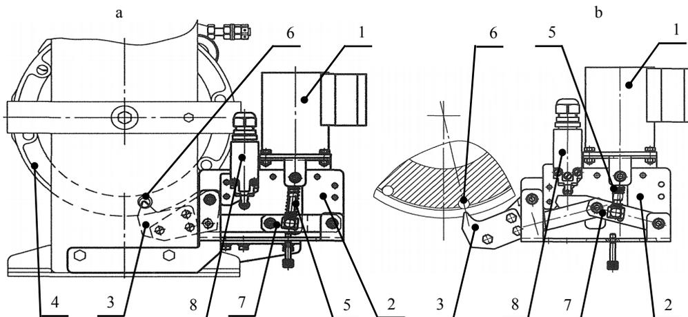
Рис. 4. Устройство стопорное навесное на ограничитель скорости маятникового типа (ОАО «Могилевлифтмаш»):
