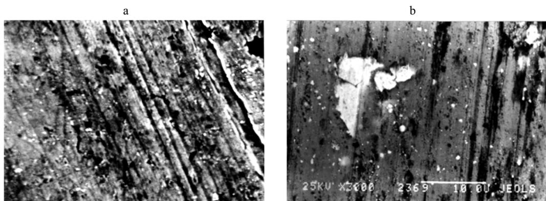
Рис. 5. Поверхность сплава ПГ-12Н-01 + 20 % В<sub>4</sub>С после изнашивания, ×3000:
