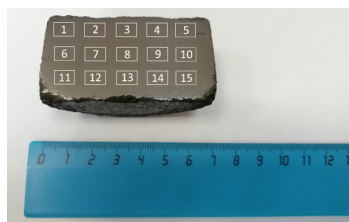
Рис. 5. Шлиф брикета из чугуновой стружки СЧ25 с указанием номеров исследуемых участков для измерения объемной пористости
