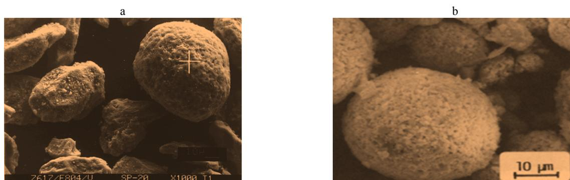
Рис. 1. Морфология полученных порошковых материалов: а – ZrO<sub>2</sub>–Y<sub>2</sub>O<sub>3</sub>, полученного химико-термическим методом; б – Al<sub>2</sub>O<sub>3</sub>–TiO<sub>2</sub> – Ni–Cr–Al–Y–Ta после проведенного процесса сфероидизации (×500)
