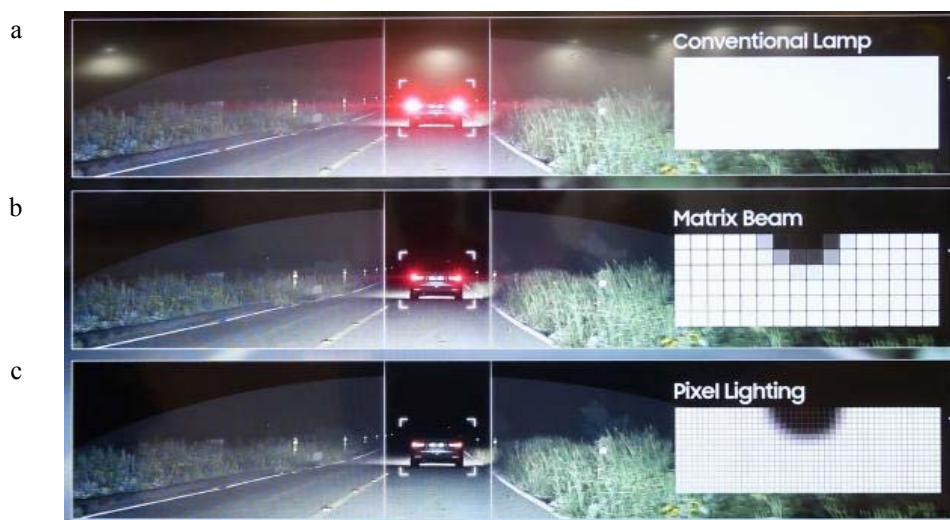
Рис. 2. Работа фары: а – обыкновенной; б – матричной; в – пиксельной
