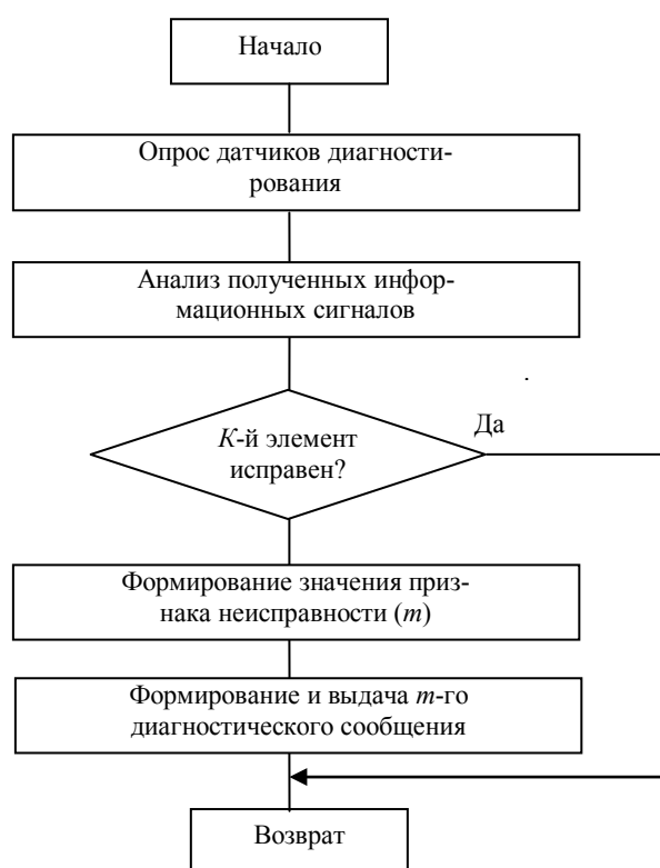
Рис. 3. Укрупненная блок-схема алгоритма бортового диагностирования технических средств и объекта диагностирования
