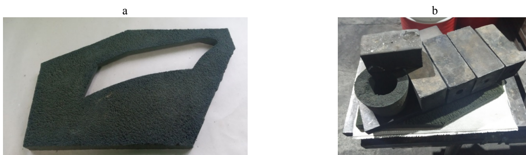
Рис. 7. Оснастка для литья детали «Лист подкладной УЗ.1,1»: а – средняя часть из холодно-твердеющей смеси; б – комбинированная форма в сборе
