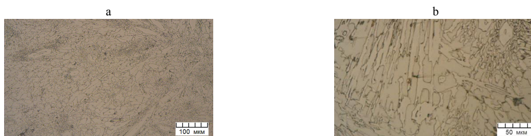
Рис. 3. Микроструктура в верхней части образца, отлитого на пластину из силумина с содержанием 3–5 % Ti
