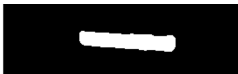
Рис. 3. Компонент бинарного изображения, соответствующий расположению номерного знака
