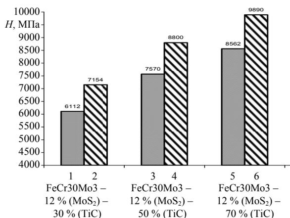
Рис. 2. Значения микротвердости износостойких покрытий из порошков металлокерамики:
