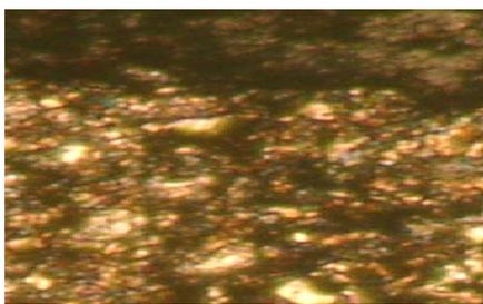
Рис. 1. Микроструктура FeCr30Mo3 – 12 % (MoS<sub>2</sub>) – 50 % (TiC) покрытия после импульсно-плазменной обработки, ×500
