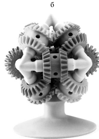
Рис. 4. Схема установки для моделирования распределением расплава (а) и образец изделия, выращенного в сборе (б)
