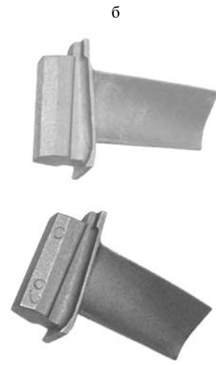
Рис. 2. Схема установки для избирательного спекания порошков (а) и образцы изделий (б)
