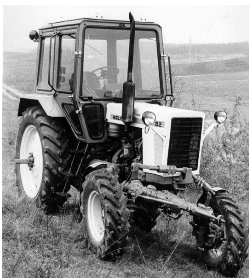
Рис. 10. Горно-равнинная модификация трактора МТЗ-82 с унифицированной кабиной и передним мостом с изменяемой геометрией
