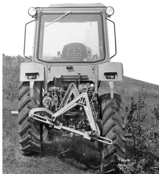
Рис. 11. Горно-равнинный трактор с механизмами автоматической стабилизации остова в вертикальном положении и корректировки сельхозмашины параллельно поверхности поля на склоне
