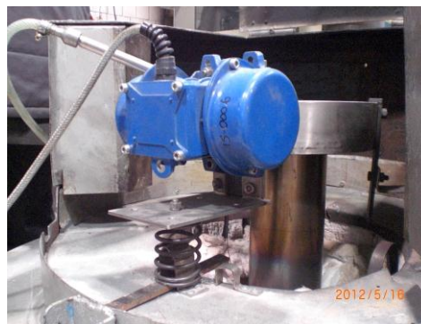
Рис. 1. Общий вид установки с печью для получения виброкипящего слоя
