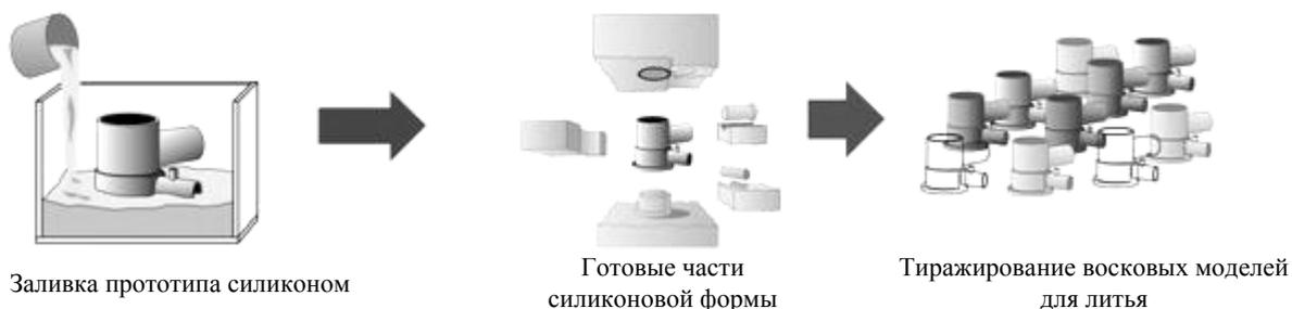
Рис. 3. Схема подготовки партии восковых моделей с использованием силиконовых форм
