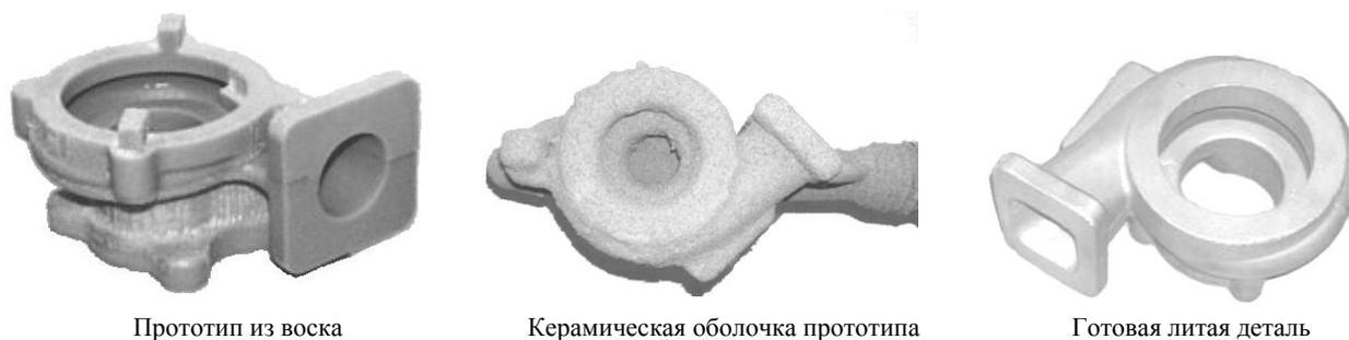
Рис. 2. Основные этапы литья по выплавляемой модели-прототипу
