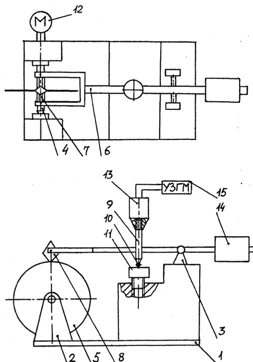
Рис. 1. Схема установки для распиливания кристаллов алмаза
