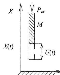
Рис. 2. Модель взаимодействия ультразвукового вибратора с жестким основанием
