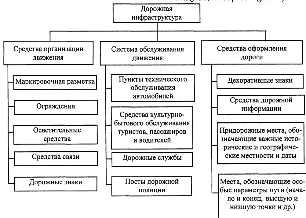
Рис. 1. Схема дорожной инфраструктуры и структура ее элементов
