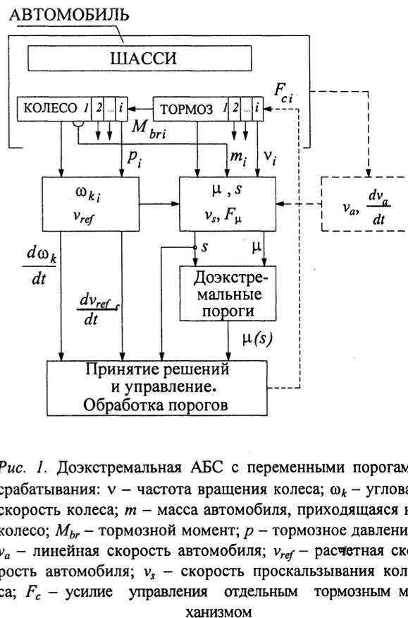
Рис. 1. Доэкстремальная АБС с переменными порогами срабатывания:  $v$  – частота вращения колеса;  $\omega_k$  – угловая скорость колеса;  $m$  – масса автомобиля, приходящаяся на колесо;  $M_{br}$  – тормозной момент;  $p$  – тормозное давление;  $v_a$  – линейная скорость автомобиля;  $v_{ref}$  – расчетная скорость автомобиля;  $v_s$  – скорость проскальзывания колеса;  $F_c$  – усилие управления отдельным тормозным механизмом
