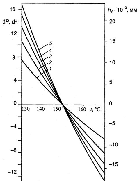
Рис. 6. Зависимость интенсивности изменения усилий на валки  $dP$  и наследственной разнотолщинности  $dh$  от температуры полосы цинка толщиной 10 мм, шириной 100 мм при абсолютном обжатии (мм): 1 – 1; 2 – 2; 3 – 3; 4 – 4; 5 – 5
