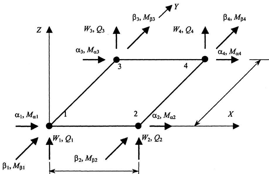
Рис. 1. Схема прямоугольного несовместного конечного элемента и перемещений его узлов
