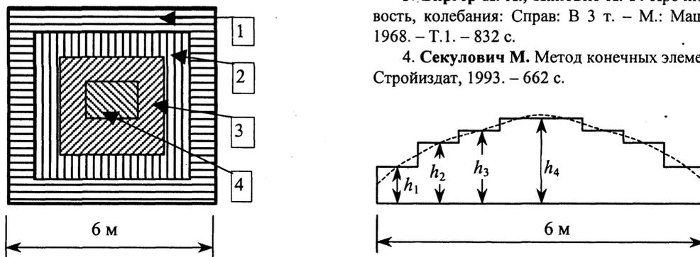
Рис. 5. Схема деления квадратной пластинки на четыре части
