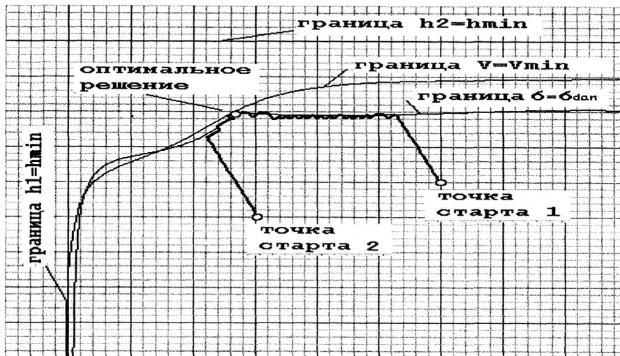
Рис. 4. Схема процесса поиска оптимального решения
