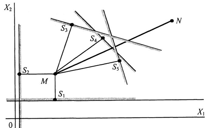
Рис. 3. Схема построения плана проекций на границы допустимой области параметров оптимизации
