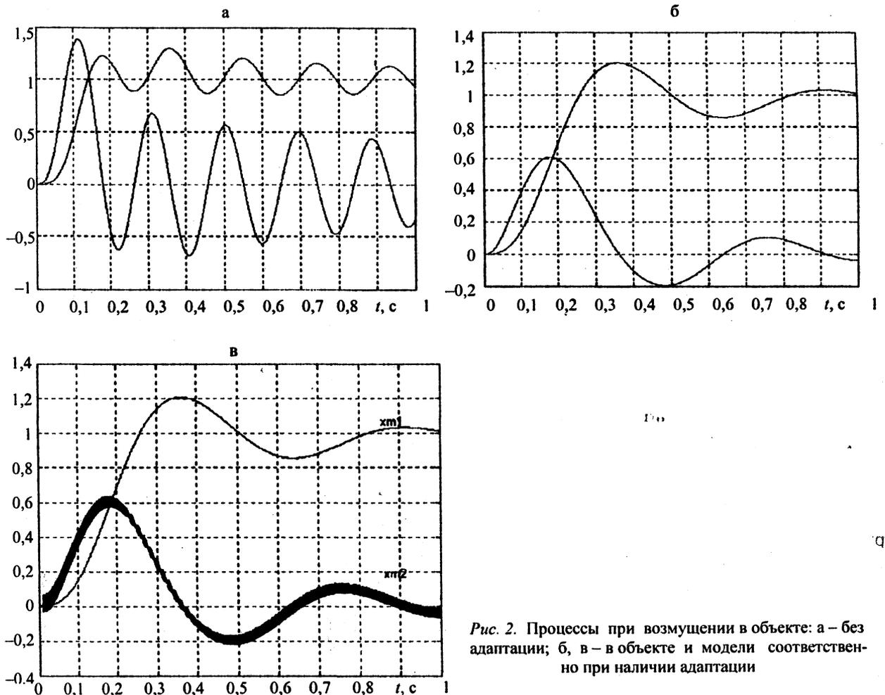
Рис. 2. Процессы при возмущении в объекте: а – без адаптации; б, в – в объекте и модели соответственно при наличии адаптации
