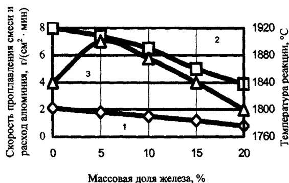
Рис. 3. Влияние содержания железа на термодинамические параметры процесса восстановления смеси на основе бора (обозначения – на рис. 2)
