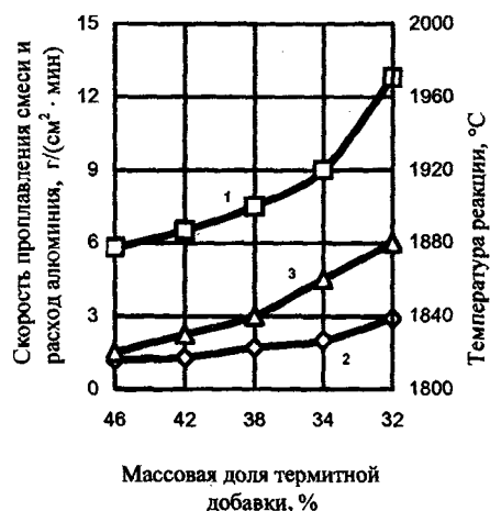
Рис. 2. Влияние содержания термитной добавки на термодинамические параметры процесса восстановления смеси на основе бора: 1 – скорость проплавления смеси; 2 – расход алюминия; 3 – температура прохождения реакции
