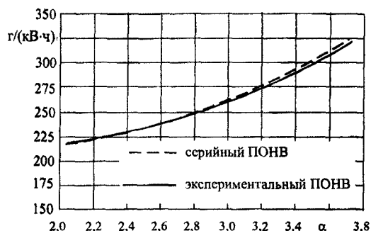
Рис. 2. Зависимость удельного эффективного расхода топлива g_e от коэффициента избытка воздуха \alpha по нагрузочной характеристике
