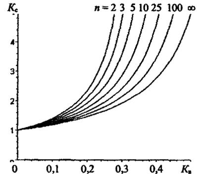
Рис. 3. Зависимость коэффициента статистического запаса от величины коэффициента вариации и количества экспериментальных значений
