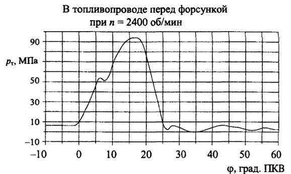
Рис. 8. Результаты индицирования и осциллографирования процессов дизеля
