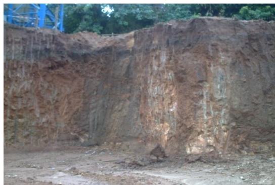
Рис. 2. Типичный геологический разрез для тропического климата Нигерии
