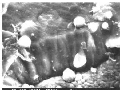
Рис. 4. Столбчатая структура титанового подслоя толщиной 4 мкм
