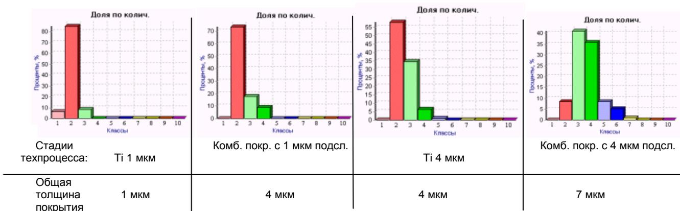
Рис. 5. Зависимость размера лунок от толщины покрытия
