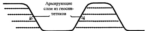
Рис. 1. Схема армирования откосов
