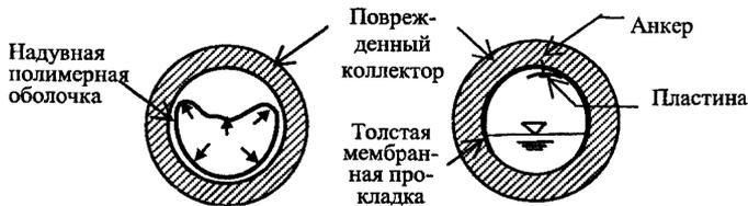
Рис. 6. Ремонт трубы с помощью геомембранной обшивки
