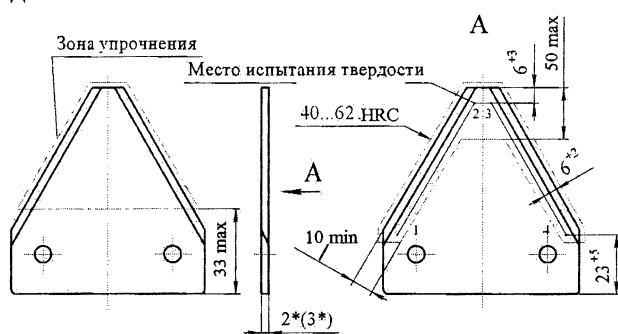
Рис. 9. Расположение участков контроля твердости
