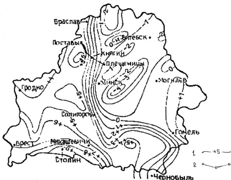
Рис. 1. Карта современных вертикальных движений земной коры Беларуси [3]: 1 – изобазы со значениями скоростей современных вертикальных движений, мм/год; 2 – фрагмент профиля фундаментальных реперов для высокоточного нивелирования на Плещеницком геодинамическом полигоне
