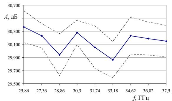
Рис. 10. График зависимости  $A \pm U_A$  ( $k = 2,0$ ;  $p = 95\%$ ) от частоты в диапазоне 25,86–37,5 ГГц, установленное значение ослабления  $A = 30$  дБ
