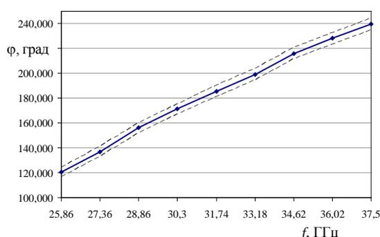
Рис. 12. График зависимости  $\varphi \pm U_{\varphi_n}$  ( $k = 1,65$ ;  $p = 95\%$ ) от частоты в диапазоне 25,86–37,5 ГГц при воспроизведении фазового набегу 180° на средней частоте
