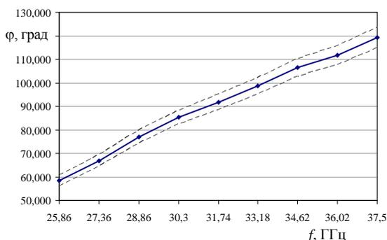
Рис. 11. График зависимости  $\varphi \pm U_{\varphi_n}$  ( $k = 1,65$ ;  $p = 95\%$ ) от частоты в диапазоне 25,86–37,5 ГГц при воспроизведении фазового набегу 90° на средней частоте
