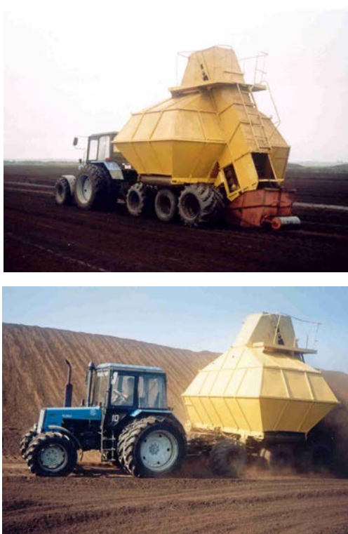
Рис. 3. Испытания уборочной машины на пневмоколесном ходу
