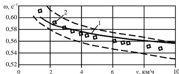
Рис. 3. Зависимости угловой скорости от скорости движения трактора «Беларус 1802»: 1 – теоретическая; 2 – экспериментальная
