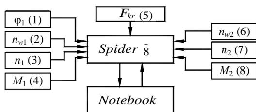
Рис. 2. Измерительный комплекс при проведении испытаний
