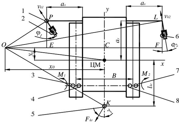
Рис. 1. Расчетная схема для определения силовых и кинематических параметров поворота гусеничного трактора
