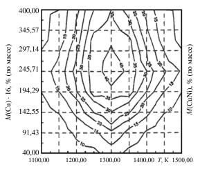
Рис. 1. Расчетная модель формирования покрытий с медно-никелевой эвтектикой в зависимости от содержания меди и температуры оплавления M(CuNi) = f[T, M(Cu)]
