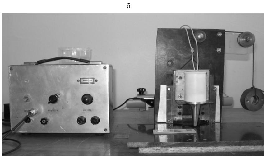
Рис. 1. Установка для моделирования процесса снятия зубных протезов при ультразвуковом виброударном воздействии: а – схема конструкции; б – внешний вид
