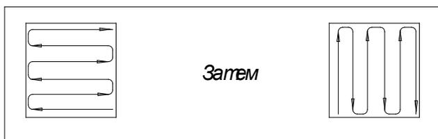
Рис. 3. Траектория перемещения образца при озвучивании
